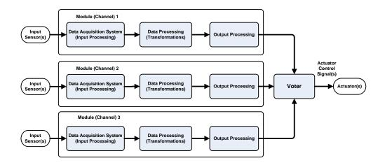
Figure 7.5.: Triple Modular Redundancy Pattern
