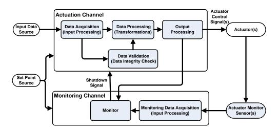
Figure 7.7.: Monitor-Actuator Pattern
